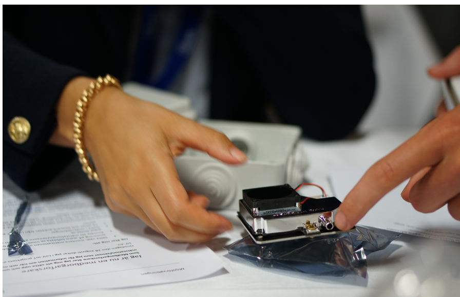
Figur 2: Bilden visar partikelsensorn och ESP8266 monteras i kopplingsdosa.
